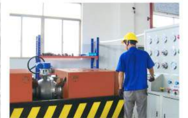
压力试验 Pressure Test
